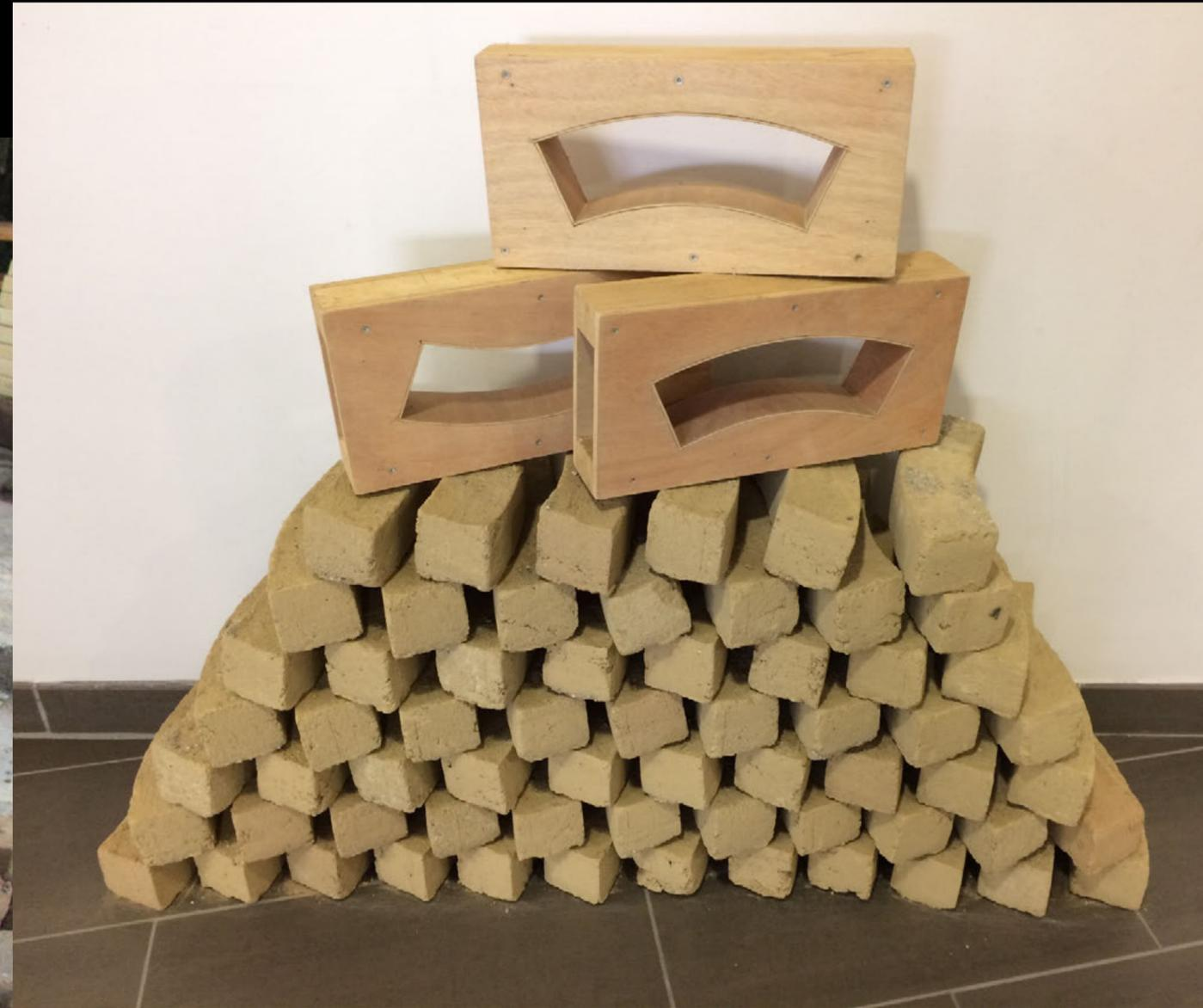
L'argile crue stabilisée peut être mise en oeuvre dans des coffrages.
