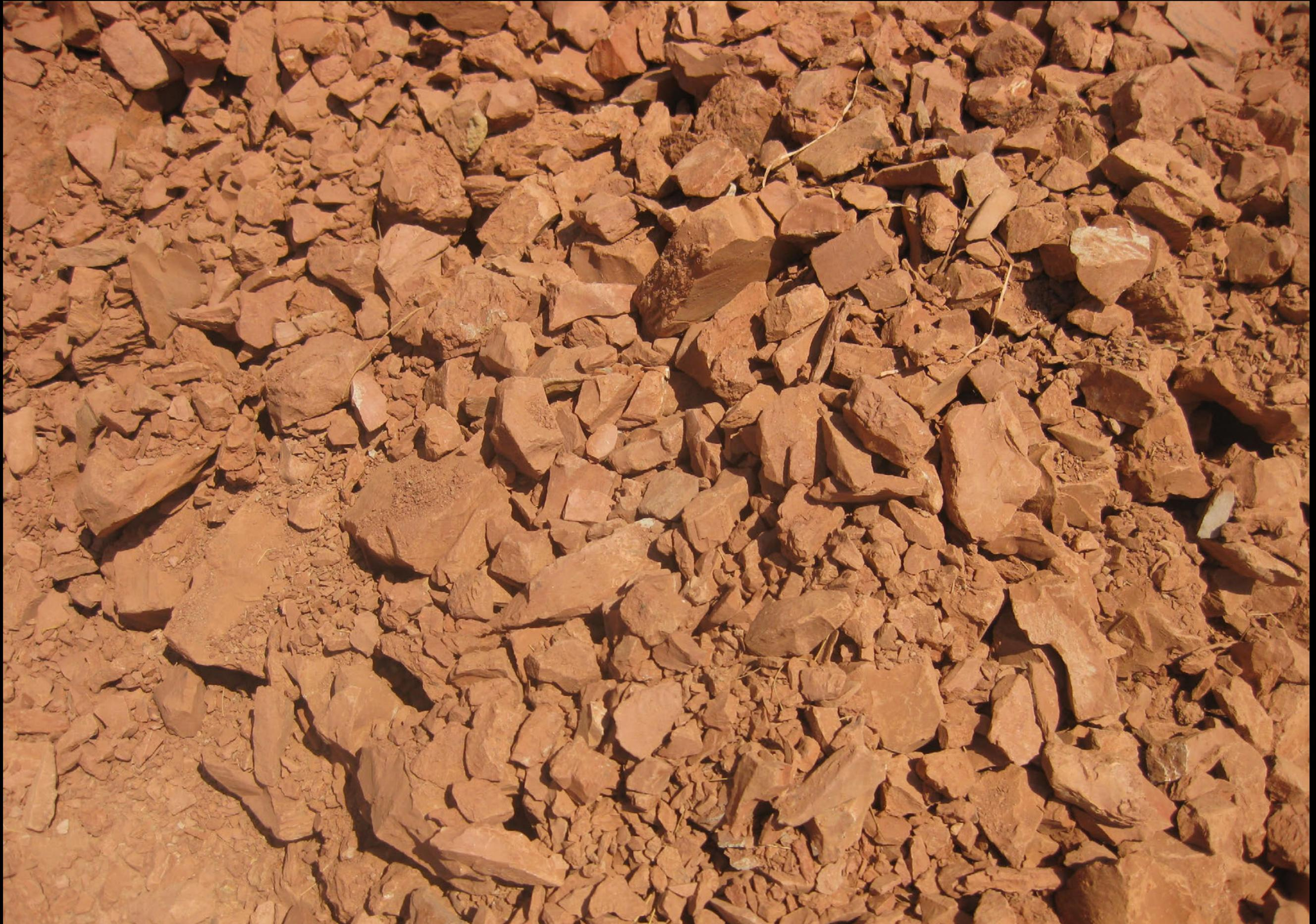
En absorbant l'eau l'argile devient plastique, maléable à la main. Sa rétraction au séchage peut créer de la fissuration pour des volumes grands ou épais.
