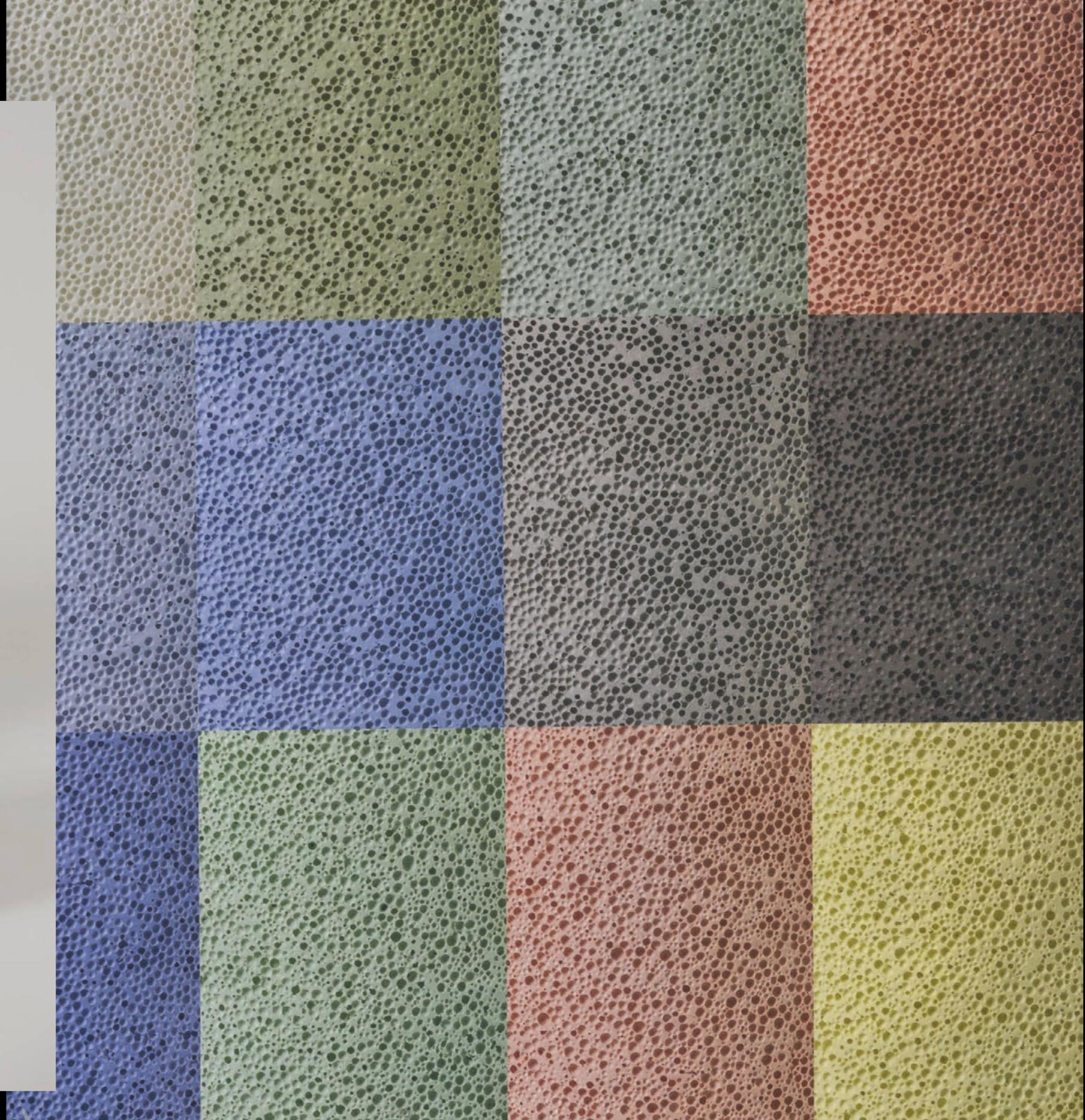
Coloration dans la masse et charge de polystyrène
